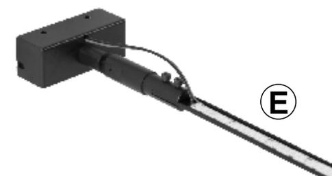
9. Tendere il supporto per strip LED mediante i due perni di regolazione **D**. Una volta messo in tensione il supporto per strip LED, procedere al posizionamento della strip LED sul supporto mediante il nastro bi-adesivo della strip LED. Collegare la strip LED al proprio alimentatore.
