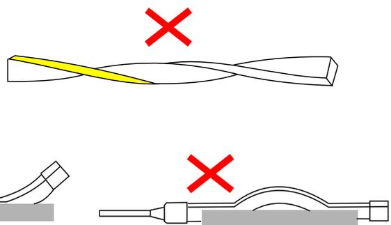
Montage und Demontage mit MAX 15° Biegung, um Schäden zu vermeiden
