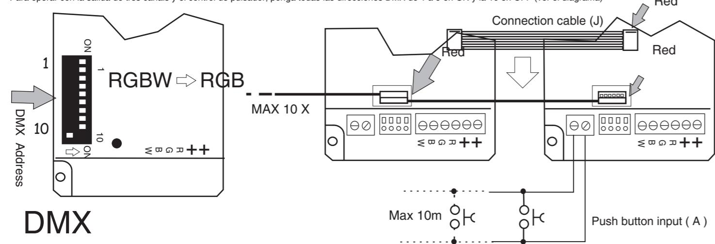
1) Collegare il sistema alla centralina DMX rispettando il cavo A e B e la polarità come indicato. Seguire le note di installazione secondo il sistema RS485-DMX
