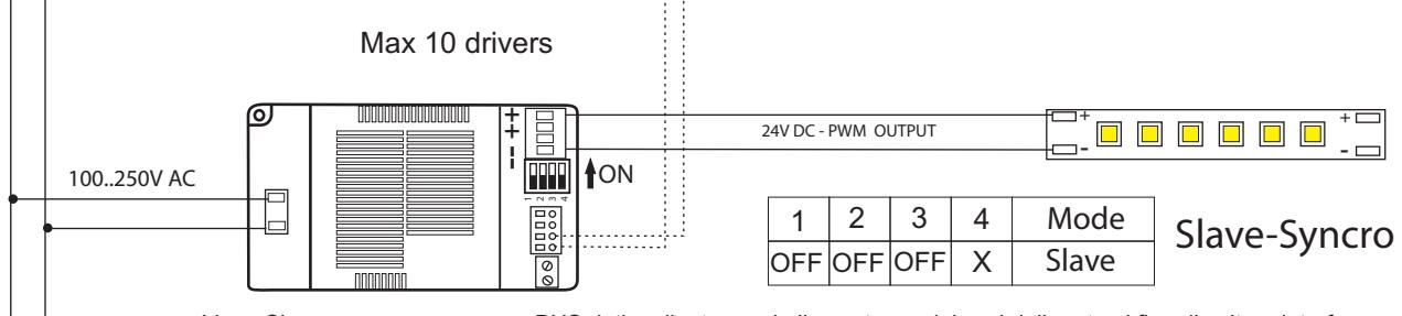
Linea Sincro: usare un cavo per BUS dati e allontanare la linea stessa dai cavi della rete al fine di evitare interferenze.
